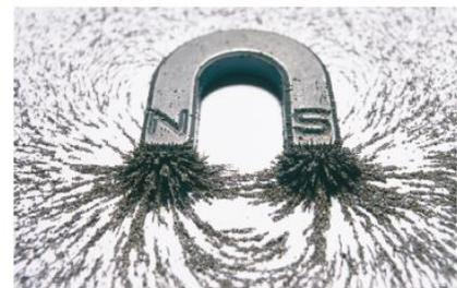
Padrão do campo magnético criado por um ímã em forma de U, obtido com limalhas de ferro.
