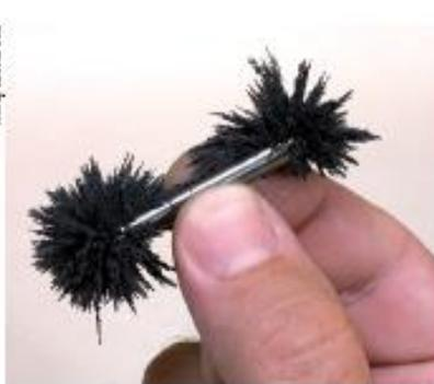
O ímã da foto entrou em contato com limalhas de ferro. Observe a maior quantidade de limalhas acumuladas em suas extremidades, nas quais se localizam os seus pólos magnéticos.
