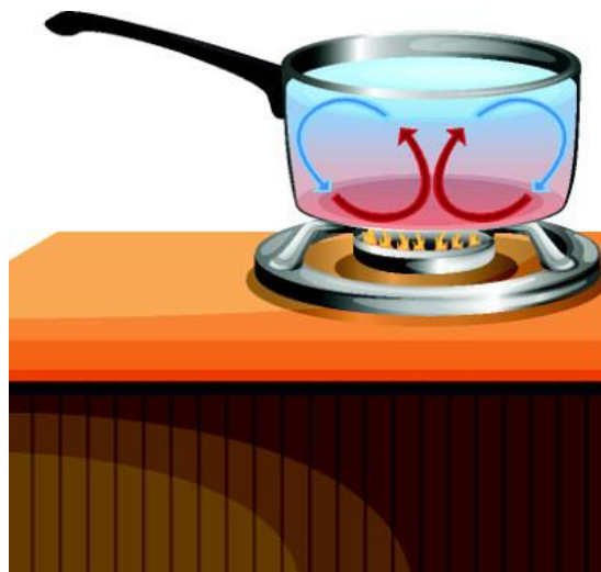
Formação da corrente de convecção no interior do líquido
