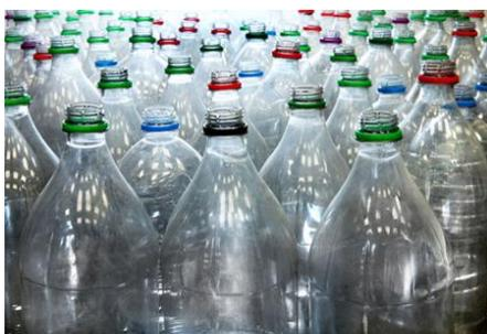
Figura 5 – Garrafas de Politereftalato de etileno(PET),um exemplo de polímeros termoplástico. Fonte: <http://sertequi.com.br/category/garrafas-pet/>
